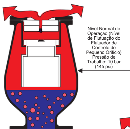
3 ALÍVIO DE AR/GÁS PRESSURIZADO TUBULAÇÃO EM OPERAÇÃO
